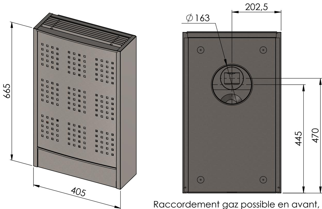
Raccordement gaz possible en avant,
